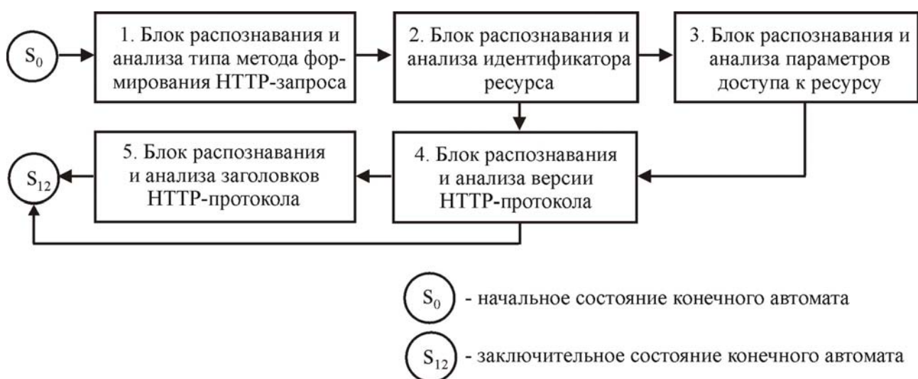
Рис. 2. Структура конечного автомата A_{HTTP}
